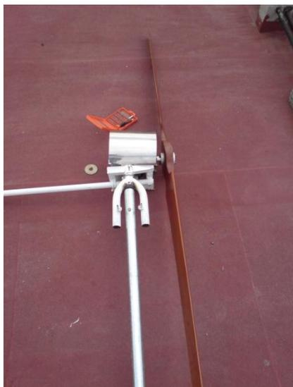
Imagen 4.84 Terminando de colocar el rotor al alternador.
