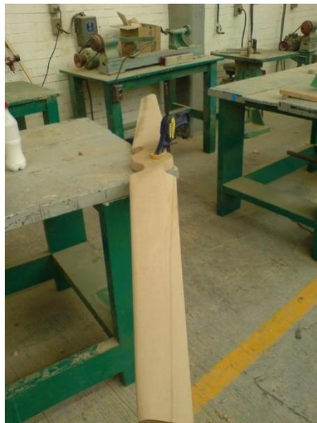
Imagen 4.29 Rellenando espacios del rotor con Resistol.
