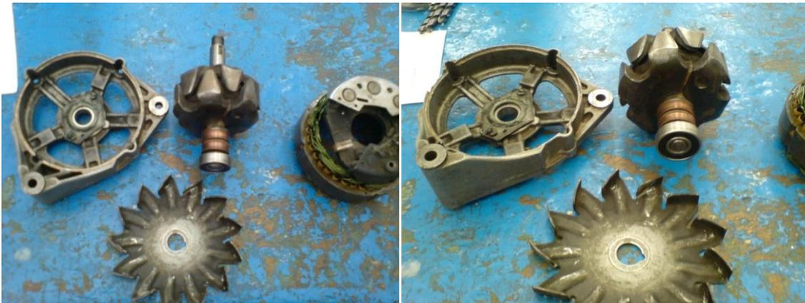
Imagen 4.40 Desmontando el alternador.
