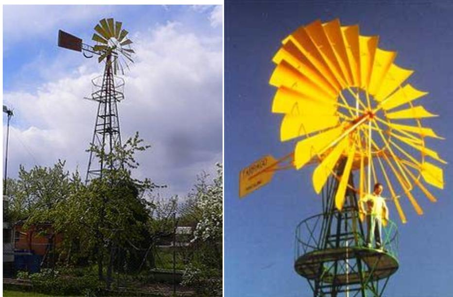
Imagen 3.13 Aerogenerador Horizontal Multipalas (Americano).
