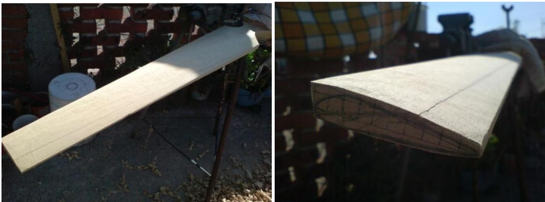
Imagen 4.27 Desbastando la parte superior de la pala.
