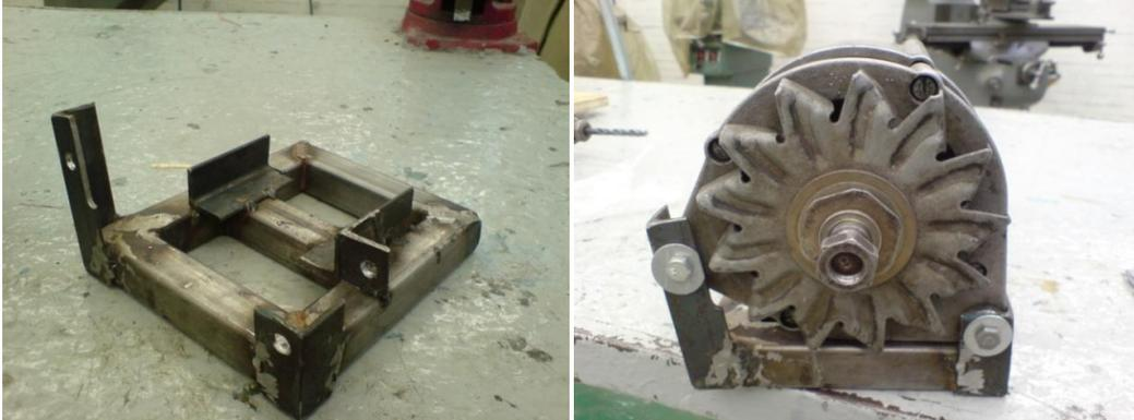
Imagen 4.60 Terminada de barrenar la base y colocando el alternador, con sus respectivos tornillos.
