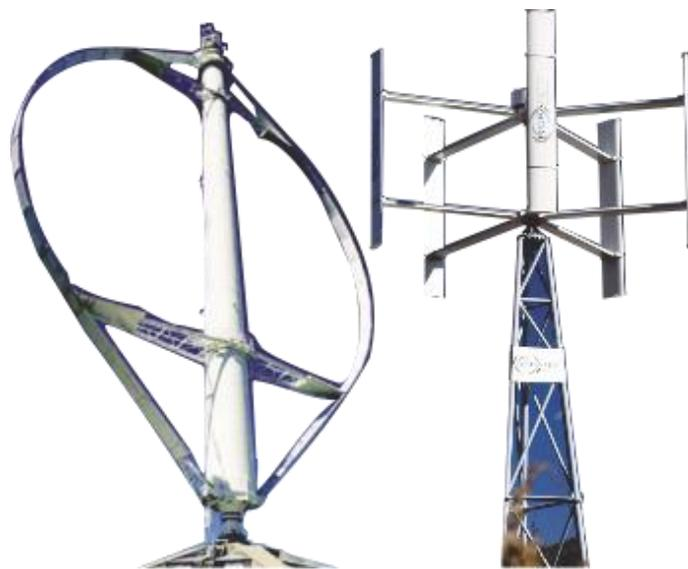
Imagen 3.1 Aerogeneradores tipo Darrieus.
