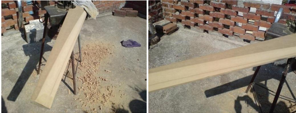
Imagen 4.26 En empezando el desbastando la parte superior de la pala.
