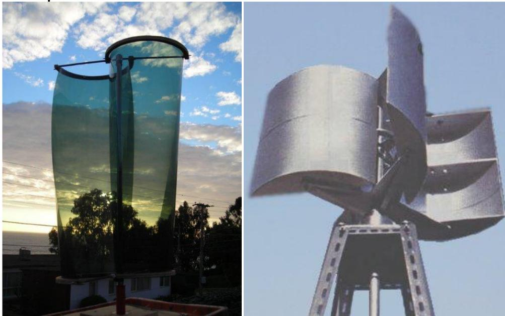
Imagen 3.11 Aerogeneradores Savonius Bipala y Tripala.
