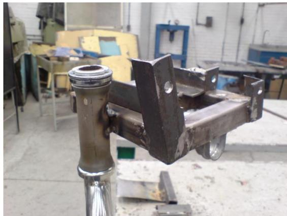
Imagen 4.66 Punteando base, con dispositivo de orientación.
