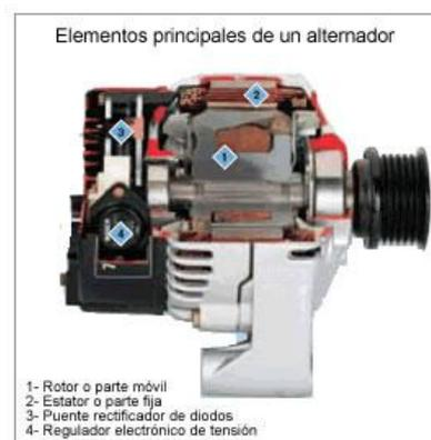
Imagen 4.5 Elementos principales de un Alternador.
