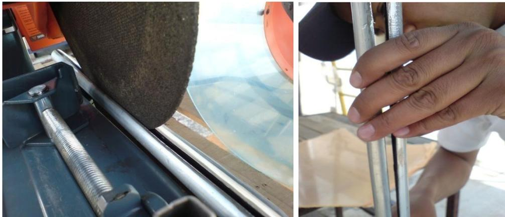
Imagen 4.71 Separando el espacio generado por el corte de la tronadora.
