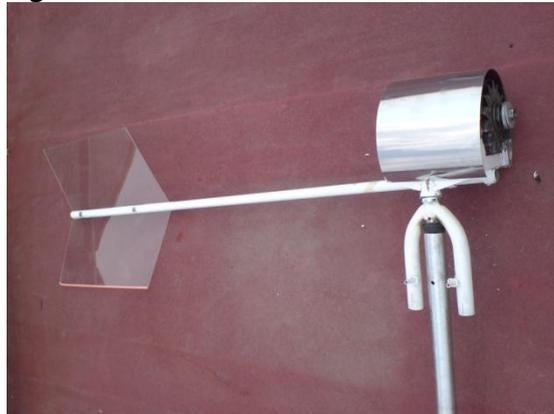
Imagen 4.83 Terminado el barrenado que sujeta el mini aerogenerador, al tubo.
