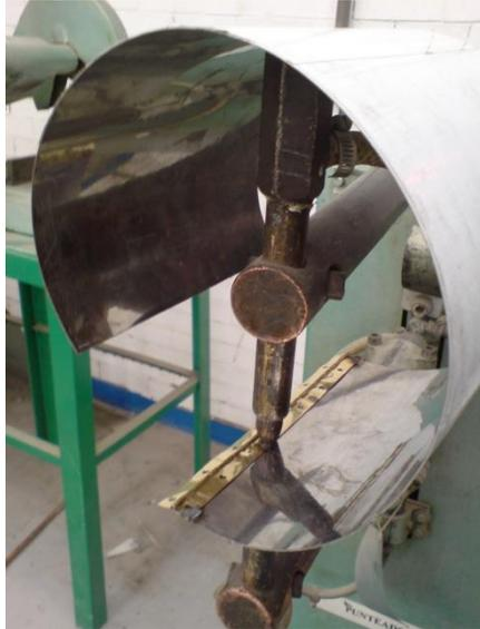
Imagen 4.80 Soldando la bisagra de piano a la lámina.
