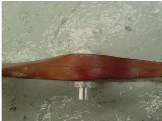
Imagen 4.50 Ensamblando el buje, con su contra, y el rotor.
