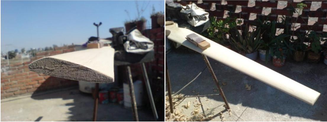
Imagen 4.28 Desbastando hasta el contorno trazado y lijado de la pala.
