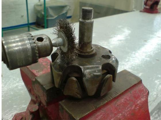
Imagen 4.41 Limpiando el rotor con una carda.
