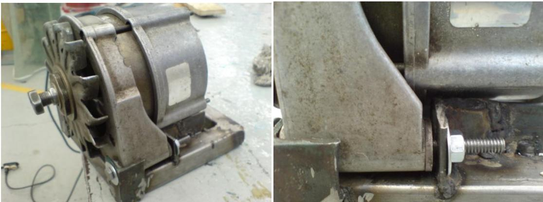
Imagen 4.61 Apretando los tornillos de la base del alternador.
