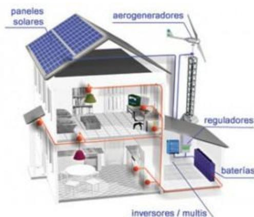
Imagen 3.22 Esquema de Instalación Híbrida (Aerogenerador con paneles Solares).
