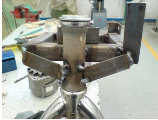
Imagen 4.67 Soldando soportes de la base al dispositivo de orientación.
