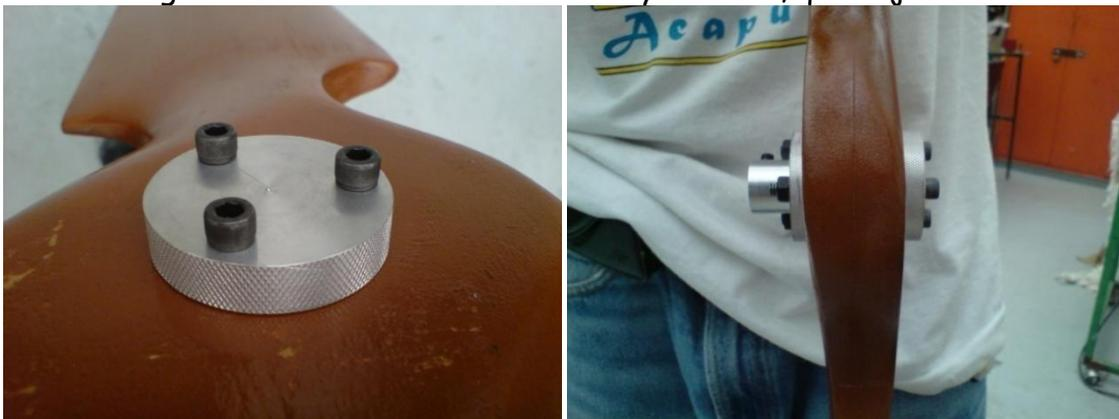
Imagen 4.55 Terminado de colocar los tornillos y tuercas en el rotor.
