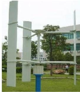
Imagen 3.4 Aerogenerador Giromill Tripala.
