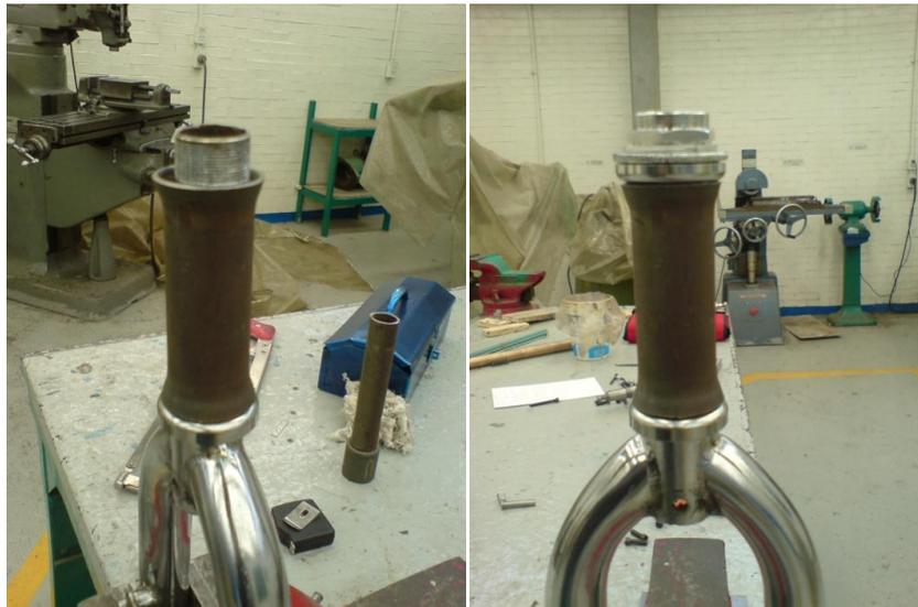
Imagen 4.64 Verificando asentado y colocando el balero superior y tuercas de presión.
