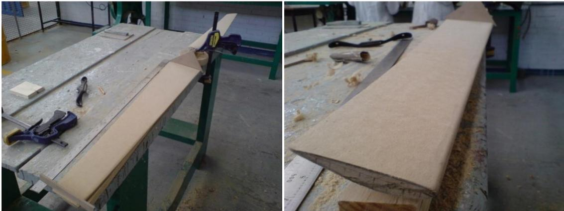
Imagen 4.33 Colocando las platillas, para verificar el perfil alar.
