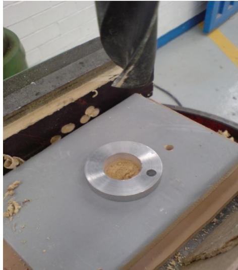
Imagen 4.48 Barrenado en la contra del buje.
