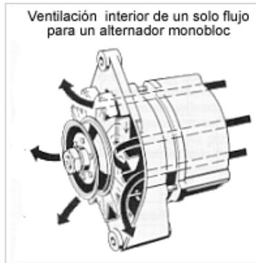
Imagen 4.12 Ventilación interior de un solo flujo para un alternador monobloc.
