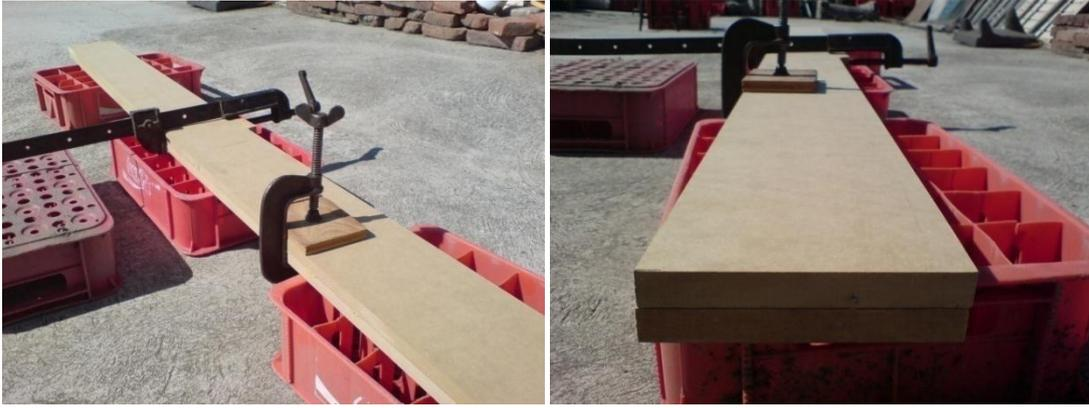
Imagen 4.17 Pegando las tablas con ayuda de la prensa en "C" y el sargento.
