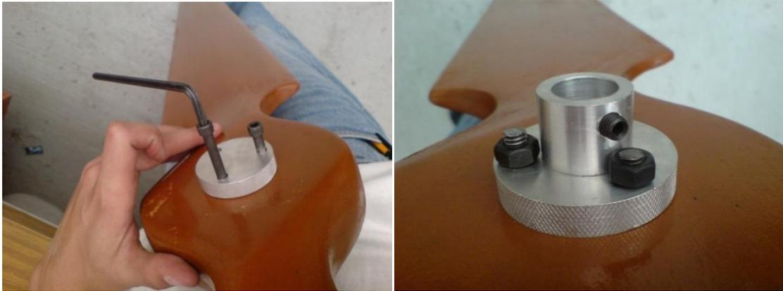
Imagen 4.54 Colocando los tornillos y tuercas, que sujetaran al rotor.
