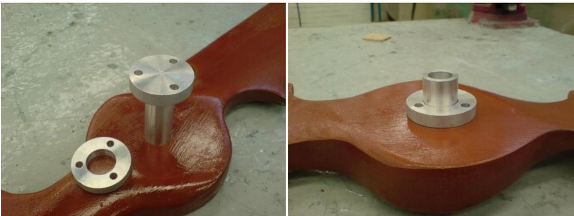
Imagen 4.52 Ensamblando el buje, contra y rotor, para marcar orificios en el rotor.
