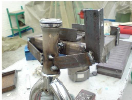
Imagen 4.68 Soldando las partes internas de la base y el dispositivo de orientación.
