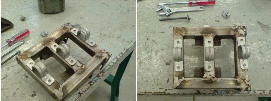
Imagen 4.62 Marcando donde se soldaran las abrazaderas en omega, en la partes inferior de la base.
