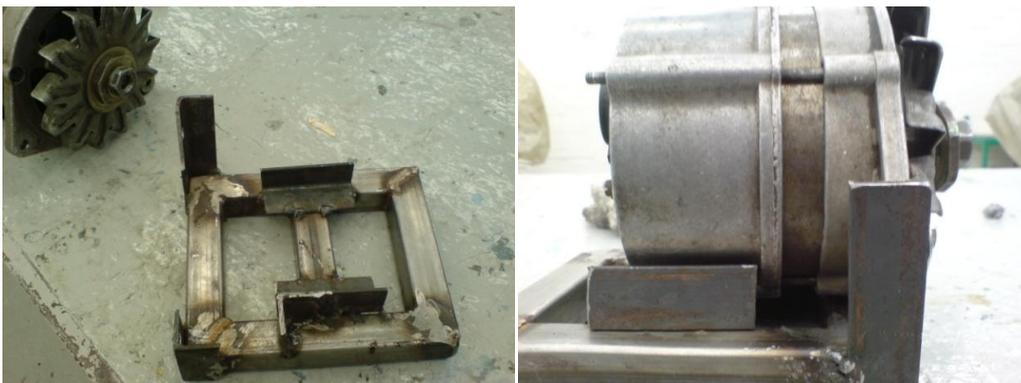
Imagen 4.59 Esmerilando puntos de la base y montando el alternador.
