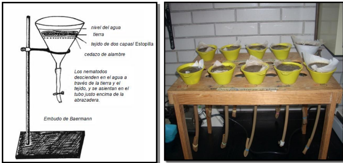
Fig. 11. Embudo de Baermann utilizado en la extracción de nemátodos.
