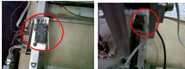
Figura 5.7 Sensores laterales del cañón (sensor lateral izquierdo y derecho, respectivamente).
