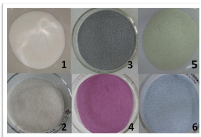
Figura 2.1. Catalizadores preparados: 1. Mo/Al 2 O 3 , 2. MoEDTA2.8/Al 2 O 3 , 3. CoMo/Al 2 O 3 , 4. CoMoEDTA/Al 2 O 3 , 5. NiMo/Al 2 O 3 , 6. NiMoEDTA/Al 2 O 3 .
