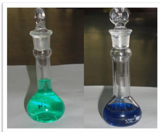
Figura 2.3 Cambio de color de las disoluciones de impregnación para el catalizador NiMoEDTA/Al 2 O 3 .
