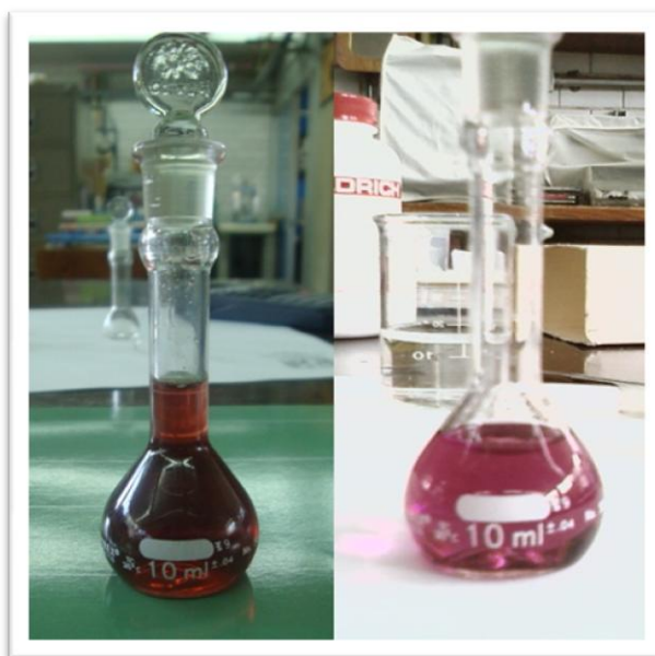
Figura 2.2 Cambio de color de las disoluciones de impregnación para el catalizador CoMoEDTA/Al 2 O 3
