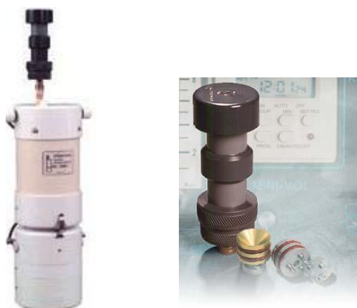
Figura 5.4 Sistema de muestreo MiniVol y portafiltros con impactores.
