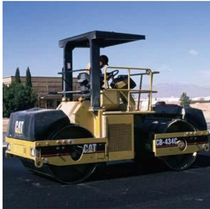
Imagen 7.3.26. Compactador de rodillo liso vibratorio.
