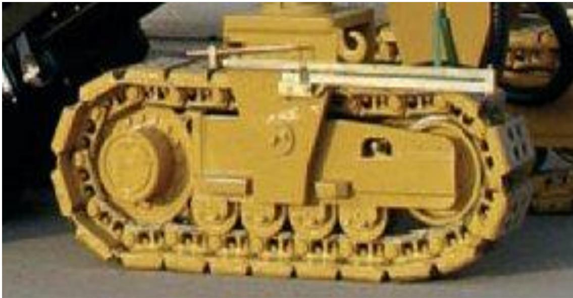
Imagen 7.3.8. Sistema de propulsión de una perfiladora de asfalto.
