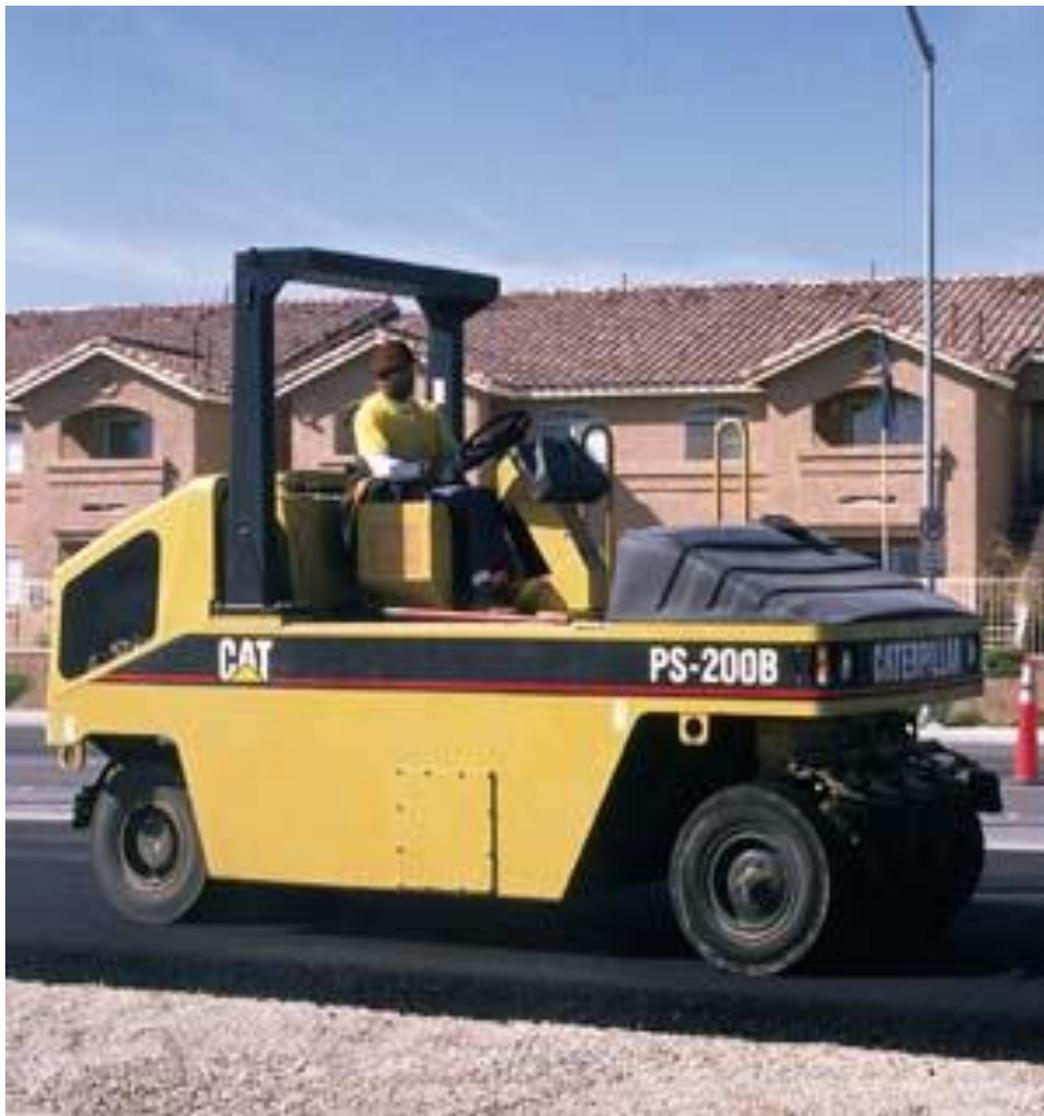
**Imagen 7.3.28.** Compactador de tipo Neumático
