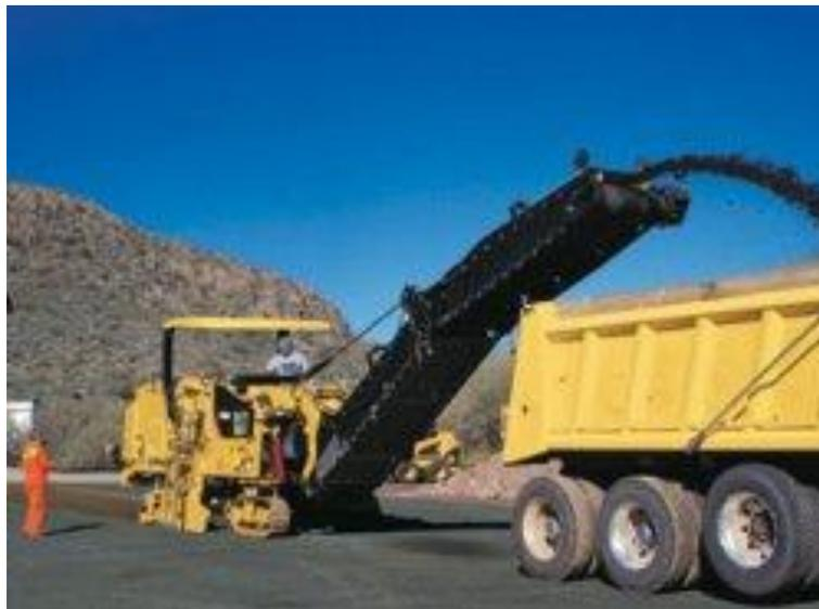
**Imagen 7.3.13.** Banda transportadora plegable de una perfiladora de asfalto.
