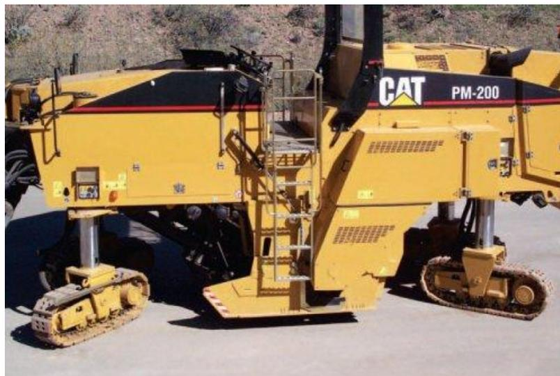
Imagen 7.3.16. Maniobrabilidad de una perfiladora de asfalto (articulación)
