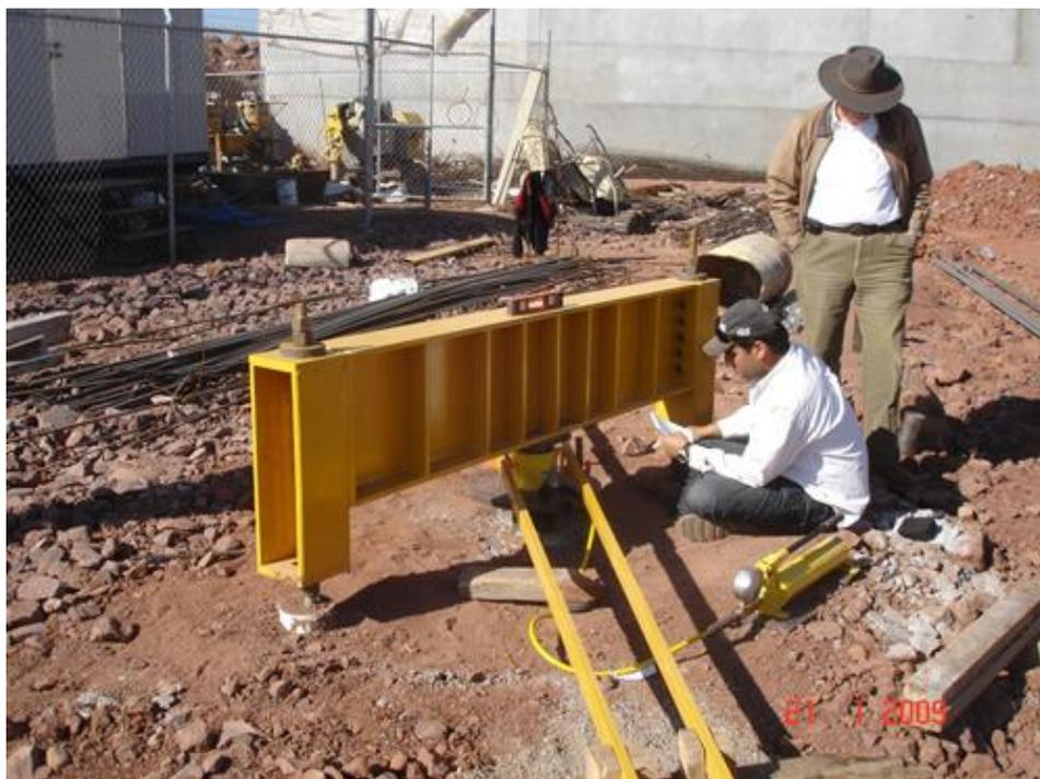
Figura 6.5.10. Dispositivos para Prueba de Placa en Aeropistas.
