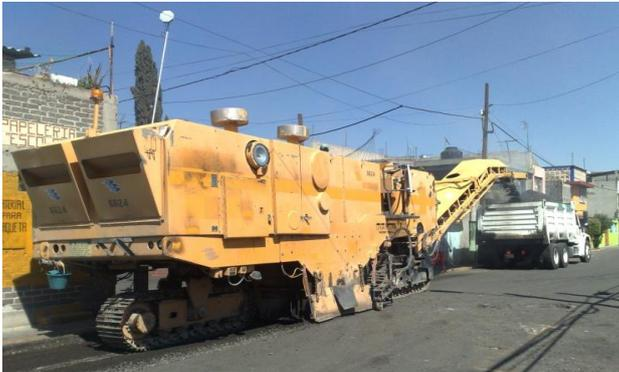
Corte, escarificado y cargado del camión con producto de la molienda de asfalto con ayuda de la banda transportadora .
