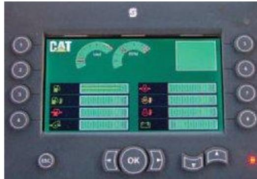
Imagen 7.3.15. Sistema de monitoreo de una perfiladora de asfalto.
