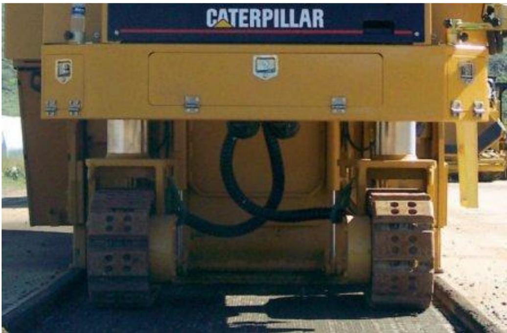
Imagen 7.3.7. Sistema de propulsión de una perfiladora de asfalto.
