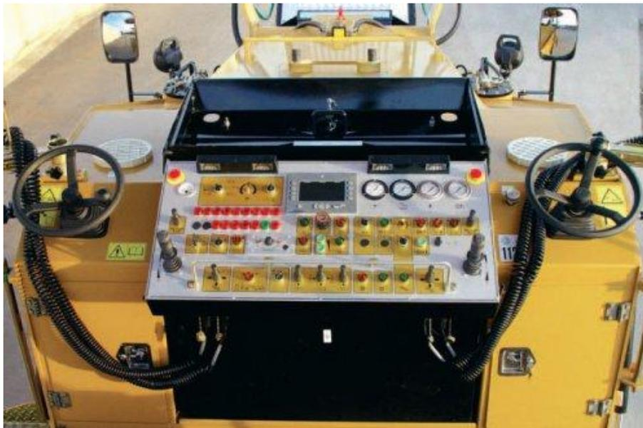
**Imagen 7.3.14.** Estación de operación de una perfiladora de asfalto.
