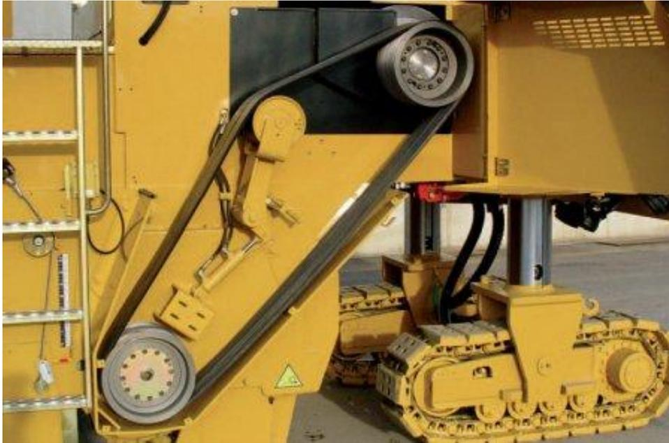
Imagen 7.3.9. Mando del rotor de una perfiladora de asfalto.
