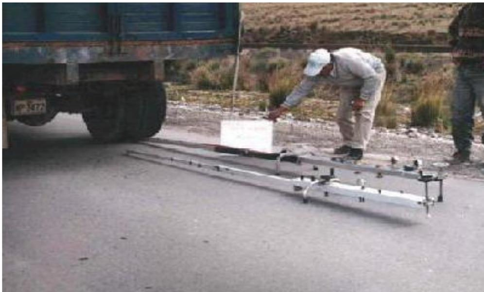
Figura 6.5.5. Operación con Viga Benkelman.
