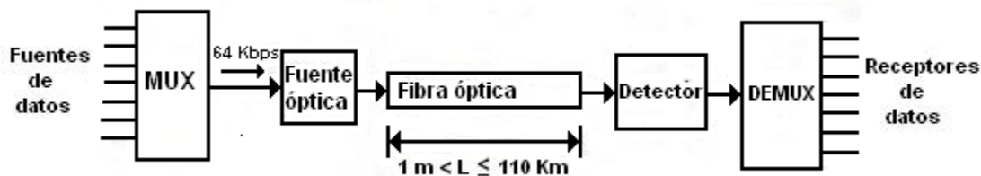
Figura 7-1. Enlace por fibra óptica, de 64 Kbps.
