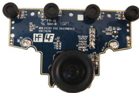
Fig. 4.2: PCB de la cámara PS3 EYE
