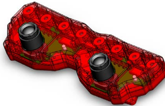
Fig. 1.7: Arreglo estereoscópico de cámaras
