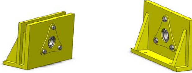
Fig. 2.5: Bases para rodamientos del tornillo sin fin
