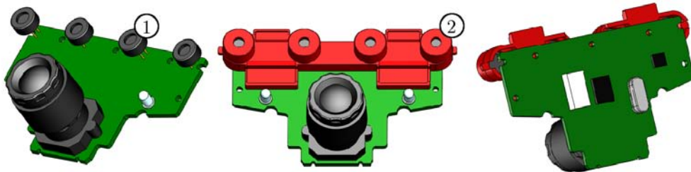
Fig. 4.3: Modelo virtual de la cámara PS3 EYE: 1) micrófonos, 2) protector de micrófonos
