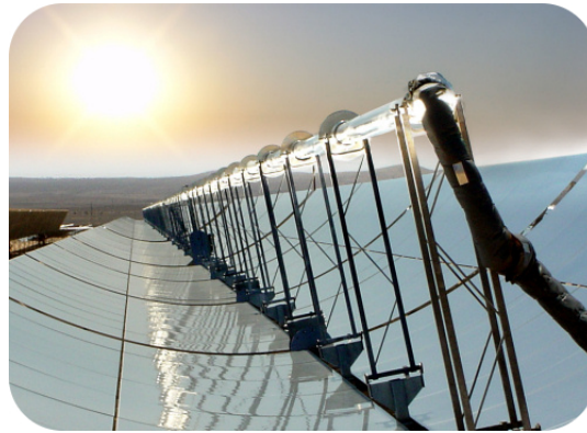
Fig. 3: Concentrador solar de canal parabólico [33]
