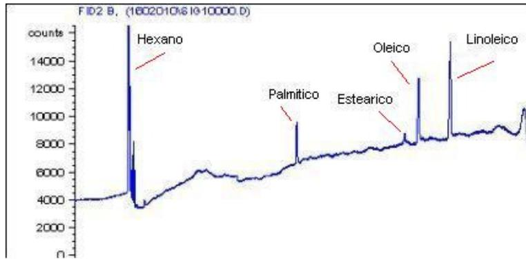
**Fig. 17.** Cromatograma de la extracción soxhlet de semillas enteras
