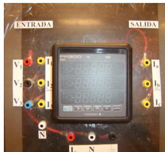
Figura 1.11 Analizador de Energía
