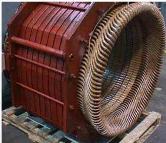
Figura 3.1 Estator de una máquina síncrona
