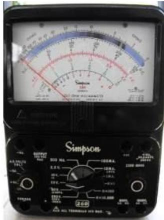
Figura 1.6 Multímetro analógico Simpson utiliza el mecanismo de d'Arsonval
