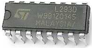
Fig. B7.- A) Circuito integrado L293D y B) Diagrama de conexión para un motor con giro en ambos sentidos.
