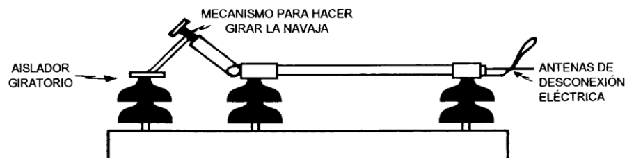
Figura 2.21 Cuchillas con tres aisladores de doble arco (tipo AV).
