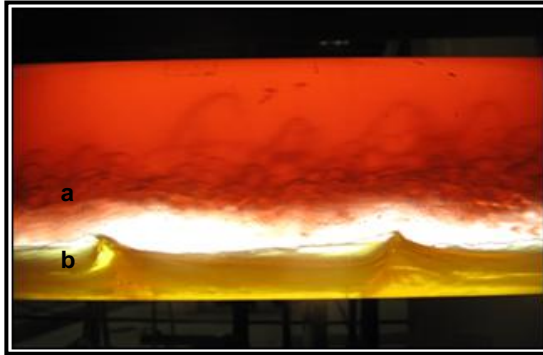
Fig.4.6 Flujo estratificado con mezclado en la interfaz, b) con lecho móvil (generación de olas o dunas) de FNN.
