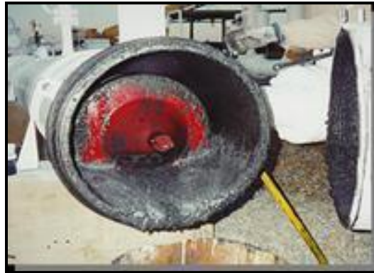
Fig.1. 6 Lodo acumulado en las partes bajas del ducto ( www.brenntagla.com ).
