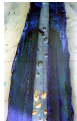
Fig. 46 ElAyouti reporta que el sistema Guttaflow ® demostró tener burbujas de aire atrapadas en la obturación. 19
