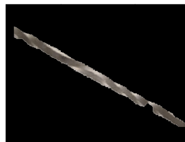
Fig. 18 Elongación del paso de la espira de una lima tipo K. 17
