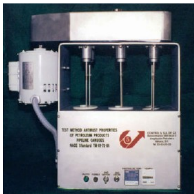
Figura 3.1. Equipo para la evaluación de la corrosividad de hidrocarburos
