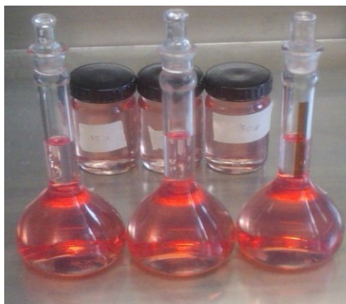
Figura 4.6. Preparación de la dosificación de inhibidor en gasolina magna.
