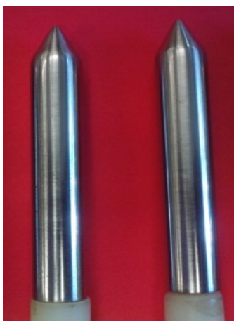
Figura 3.2. Cupón cilíndrico de acero al carbón con punta cónica
