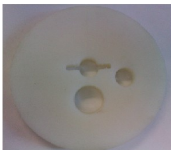
Figura 4.1. Tapa de polimetilmetacrilato.
