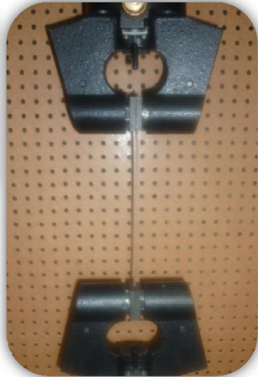
**Fig. 20** Prueba de elongación en la máquina INSTRON.
