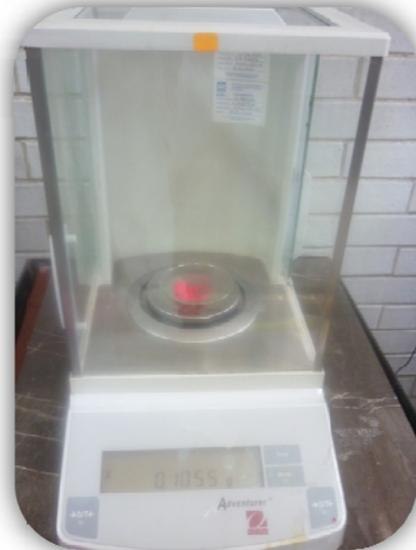
Fig. 8 Pesando 0.2 g de fibras flock.
