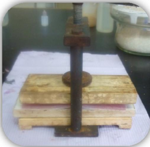
**Fig. 16** Colocación del suaje y placa de silicón en la prensa.
