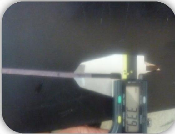
**Fig. 19** Medición del grosor de la muestra.
