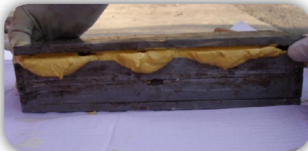
**Fig. 6 Se coloca la tapa superior eliminando el excedente de yeso.**
