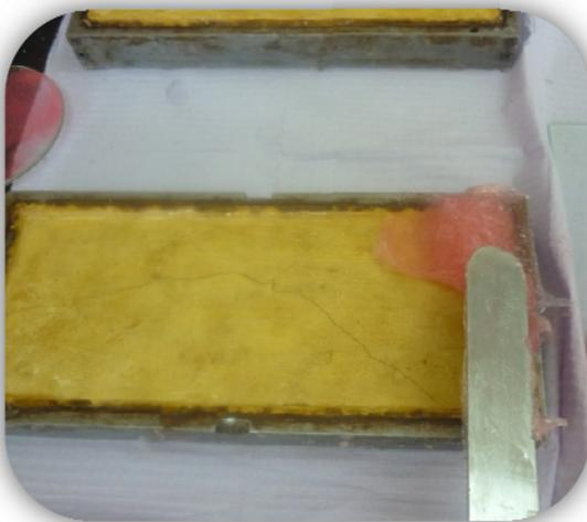
**Fig. 11 Colocación del silicón por porciones en el yeso de la mufla.**
