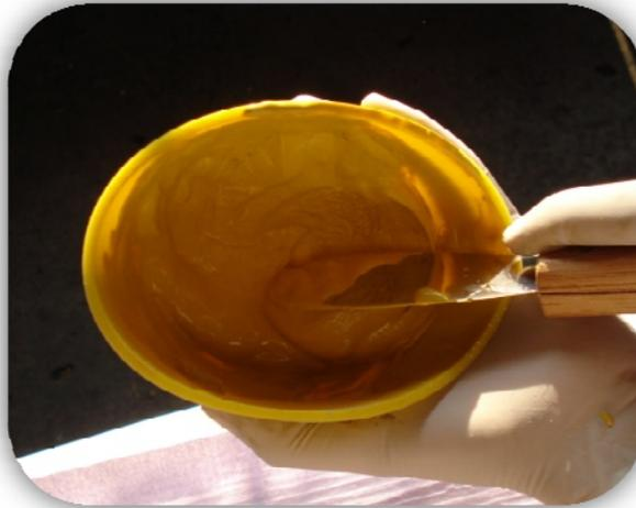
**Fig. 2 Preparación del yeso tipo III.**
