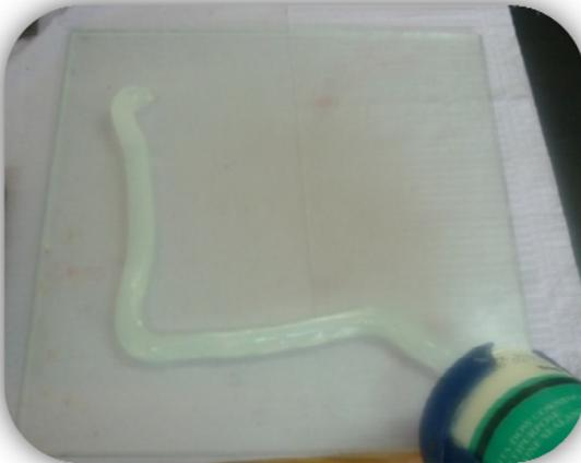
**Fig. 9 Colocación del silicón en la loseta.**
