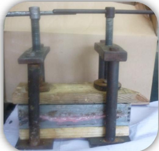
**Fig. 14 Se dejó prensado a temperatura ambiente durante 24 horas.**
