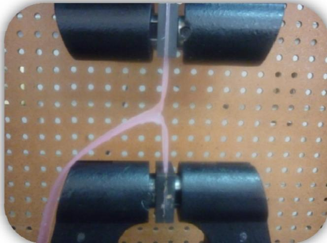
Fig. 23 Colocación de las pestañas de la muestra en las mordazas.
