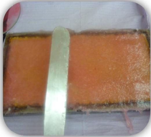
**Fig. 12 Colocación del silicón en todo el yeso.**
