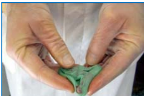
Fig.20 Mezclado del polidimetilsiloxano.
