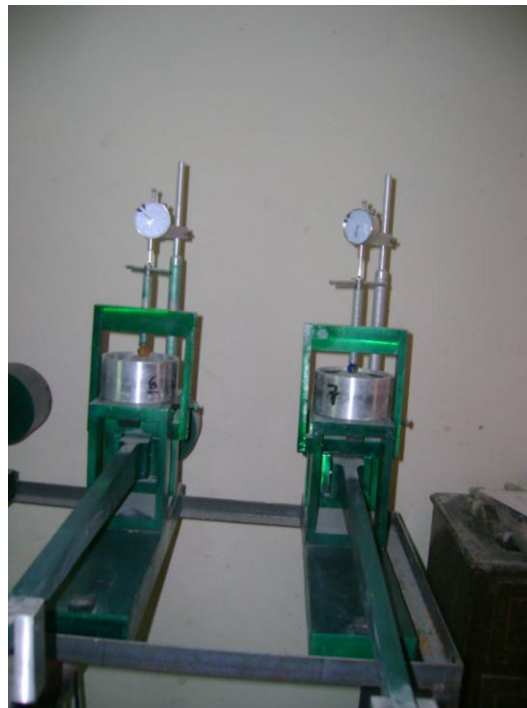
PRUEBA DE CONSOLIDACIÓN
