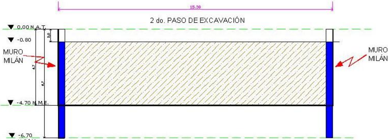
FIGURA ) Se iniciará con la construcción del muro Milán, desplantandose en la cota -6.70.
