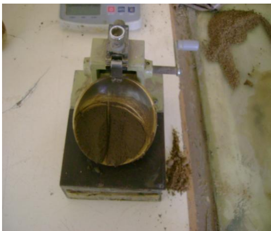
PRUEBA LIMITES DE CONSISTENCIA
