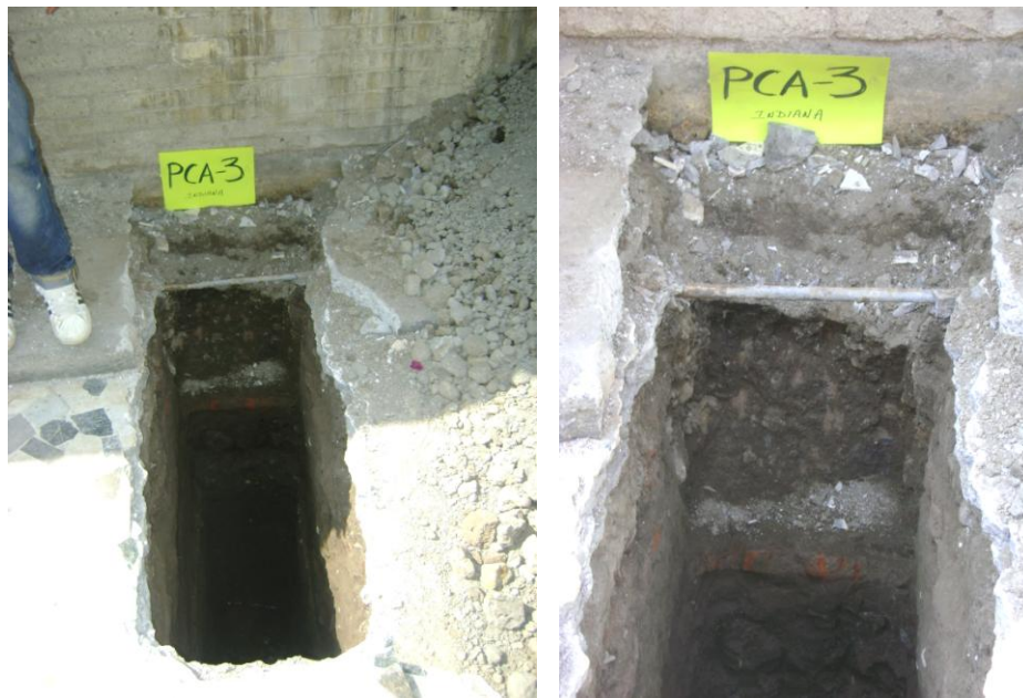
FIGURA No 9 PERFIL ESTRATIGRÁFICO DE PCA 3
