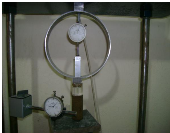
PRUEBA COMPRESIÓN SIMPLE
