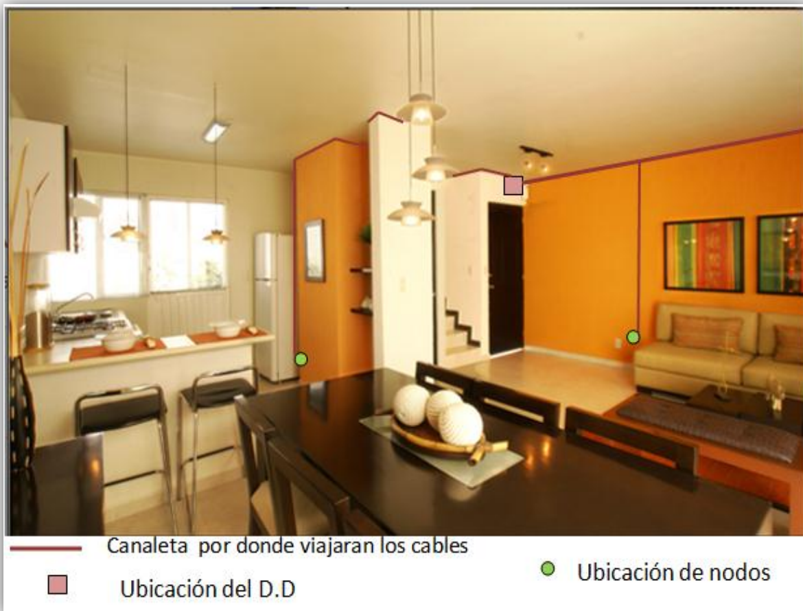
Figura 4.3.2.5 Ejemplo de la ruta por medio de canaleta y ubicación de dispositivos.
