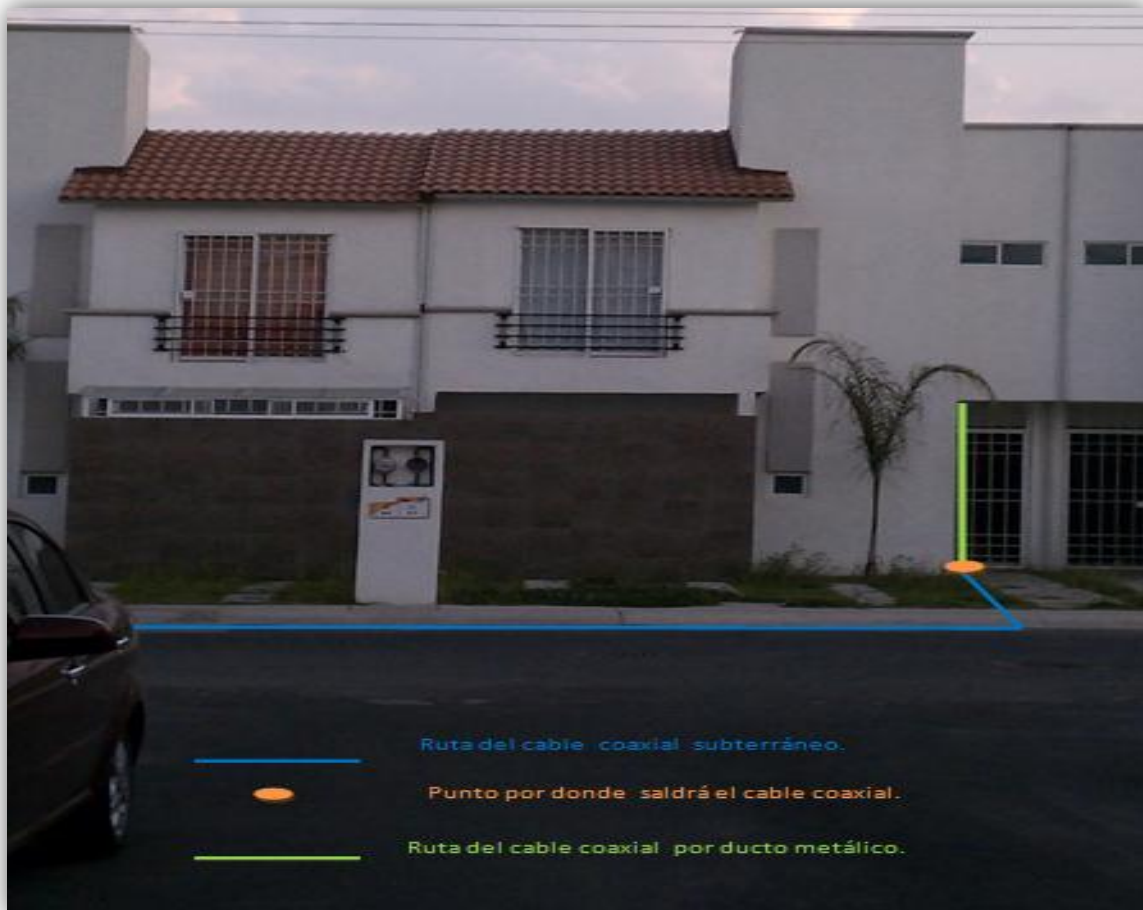
Figura 4.3.2.4 Canalización del cable coaxial hasta el D.D.
