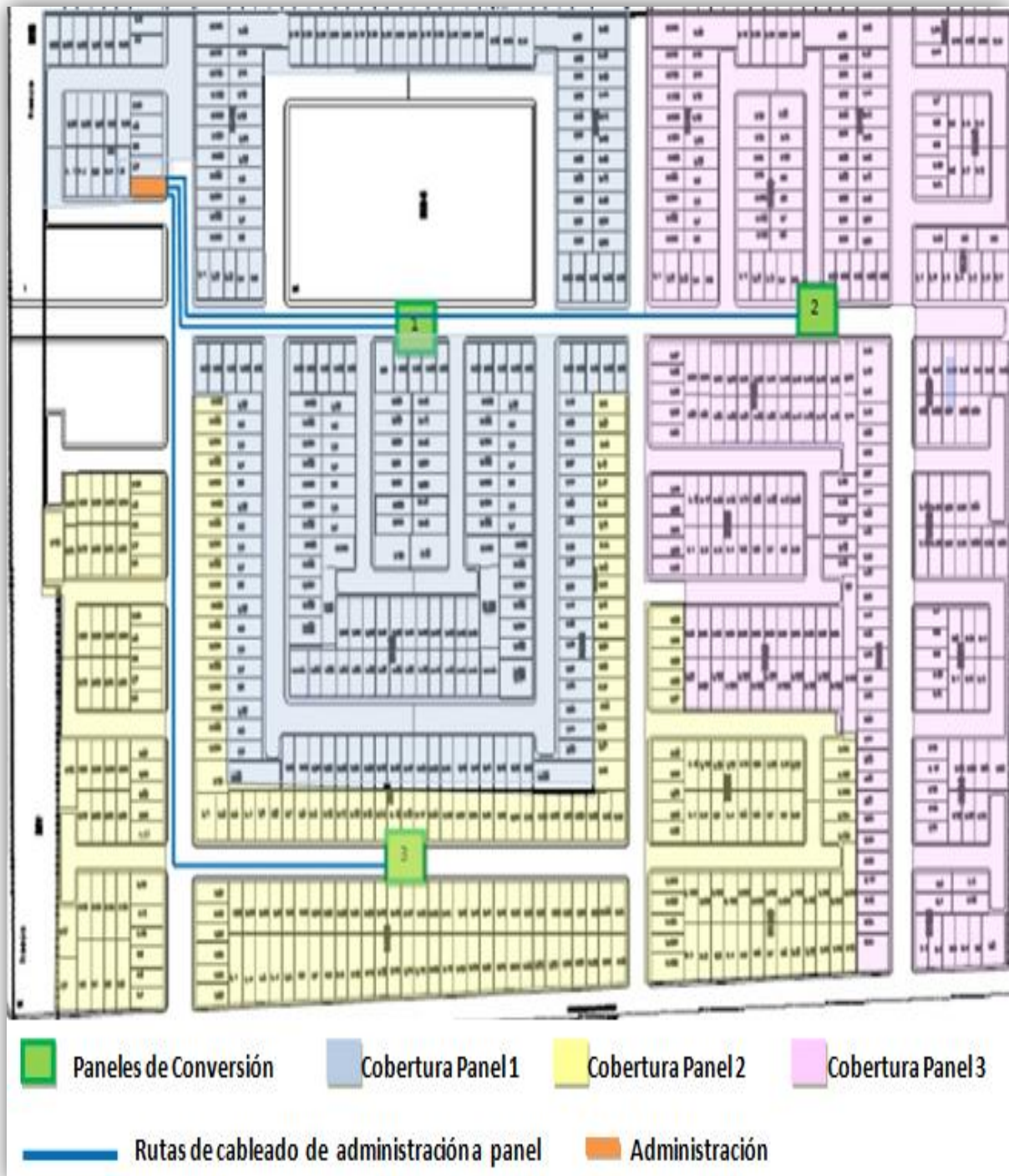
Figura 4.2.1.3 Ubicación de los Paneles de Conversión.
