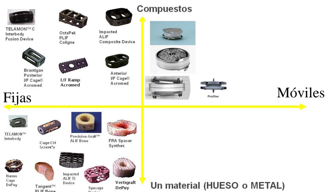
Figura 1.10 Tipos de prótesis de disco intervertebral
