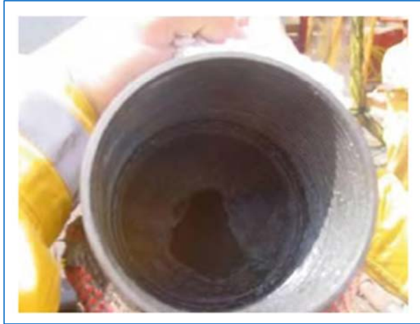
FIGURA 2.5 Formación de parafinas en tuberías de producción 29
