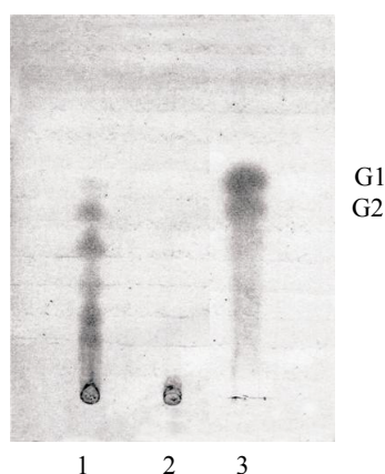
Figura 6.11. Cromatografía en capa fina de las reacciones con los productos de amyA en almidón al 4%, pH 7, 80°C, 3 h. 1) Estándar de maltodextrinas 3%, 2) Blanco: Reacción con TIM Barrel; 3) Reacción con el producto de la la expresión de amyA .
