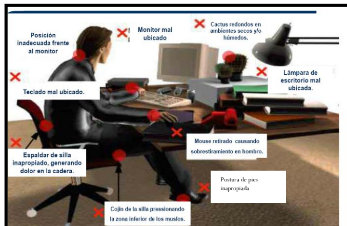
Fig. 33 Errores en la disposición del lugar de trabajo
