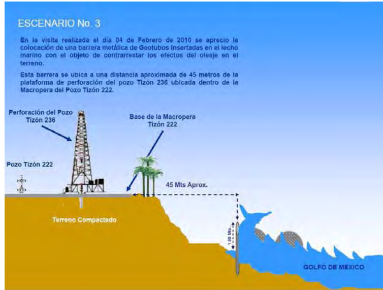
Figura B.20: Esquema de solución al construir un muro vertical para detener el proceso de erosión de la línea de costa
