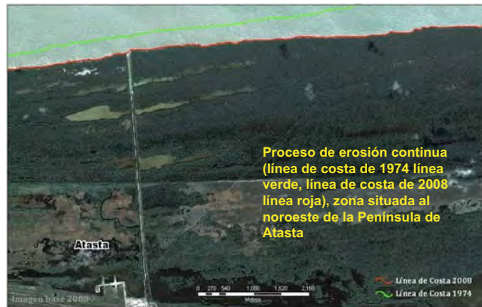
Figura B.6: Proceso de erosión continua de 1974 a 2008 en la zona de Atasta. Obsérvese el borde irregular de la zona costera
