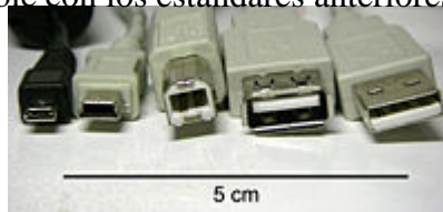
Fig. 6.7 Tipos diferentes de conectores USB (de izquierda a derecha): micro USB macho, mini USB tipo B macho, tipo B macho, tipo A hembra, tipo A macho.
