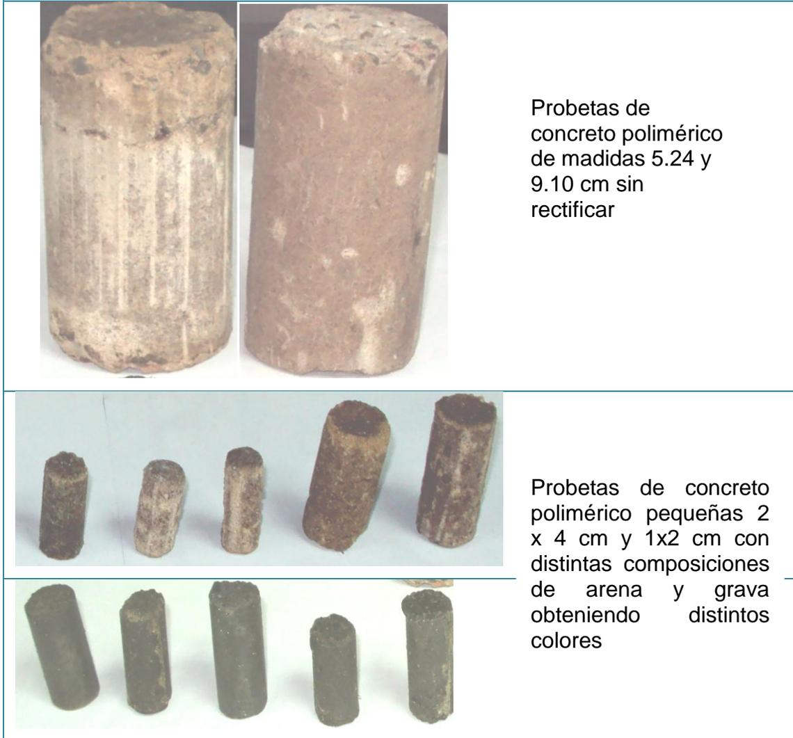
Debido a que las probetas de concreto polimérico no tenían una superficie completamente plana por lo que fue necesario lijarlas en una máquina rectificadora. Para que las probetas tocaran uniformemente los cabezales y la base de una la máquina Universal Tinius Olsen, ya que si no es así la presión ejercida por máquina no es distribuida uniformemente en toda la probeta provocando un mal resultado.
