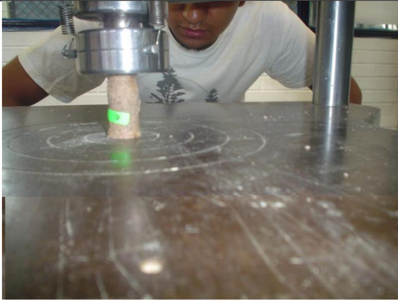
Medición de prueba mecánica en la Máquina Tinius Olsen para la probeta 2
