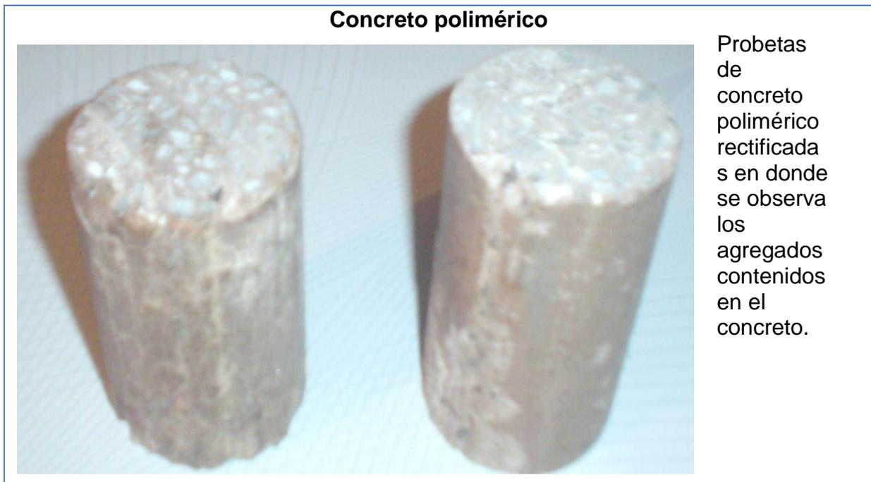
La resistencia de un concreto común está regida por la relación agua/cemento en este caso para el concreto polimérico la relación es resina/arena-grava (agregado fino-agregado grueso). La homogeneidad es un factor importante el cual está influida por la variabilidad de la arena y grava a utilizar.
