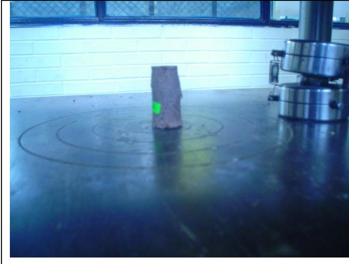
Colocación de la probeta de concreto polimérico en la máquina universal Tinius Olsen la cual debe estar en el centro para una excelente medición de la fuerza de compresión.
