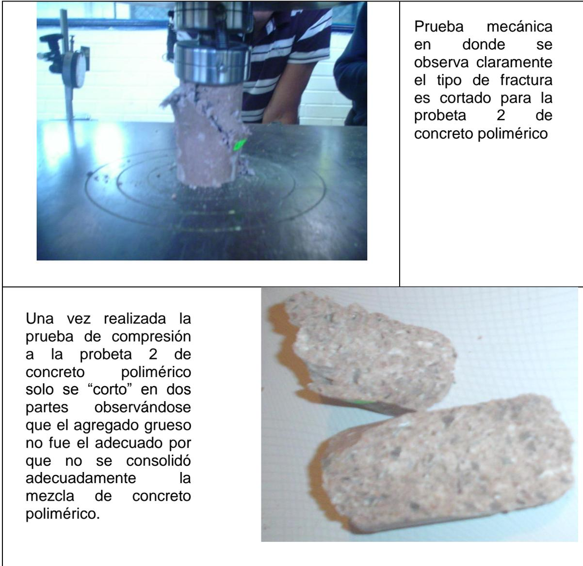
*La probeta presento un esfuerzo máximo a la compresión de  $39.60 \text{ kg/cm}^2$  debido a que la resina le falto tiempo de reacción presentando baja elasticidad. Tiene un tipo de fractura cortado, el tipo de agregado grueso influyo demasiado en el tipo de*
