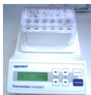
Imagen 11. Mezclador con control de temperatura Termomixer
