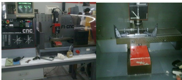
Fig. 16 Maquinado de probetas en máquinas CNC.
