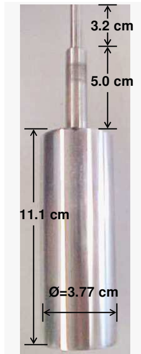
Figura 2.3. Electrodo de cilindro rotatorio (RCE)
