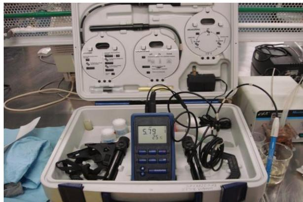
Fig. 2.1 Equipo multiparámetros para determinar T, pH, conductividad, OD y POR
