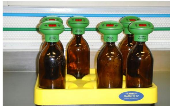
Fig. 2.5 Fotografía de equipo para DBO
