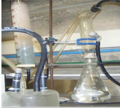
Foto del equipo de digestión y de la trampa de vapor
