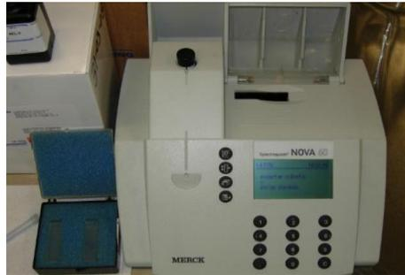
Fig. 2.2 Fotocolorímetro Spectroquant, modelo Nova 60, marca Merck
