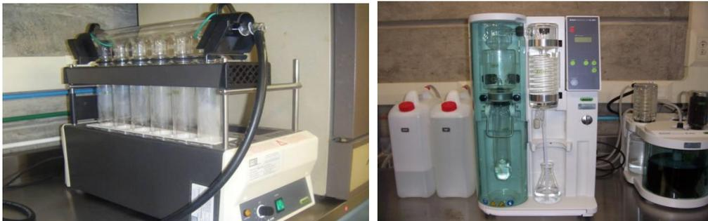
Fig. 2.3. Equipo Büchi de digestión destilación para determinar N-NH<sub>3</sub> y N total
