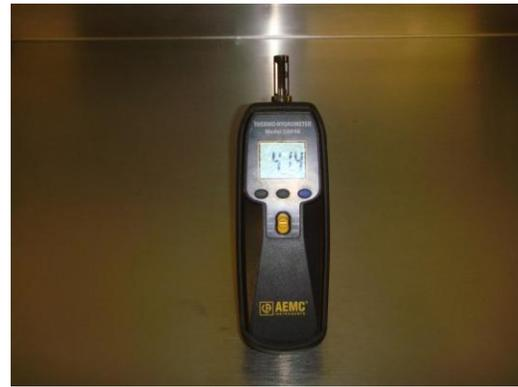
Fig. 2.7 Medidor de humedad relativa
