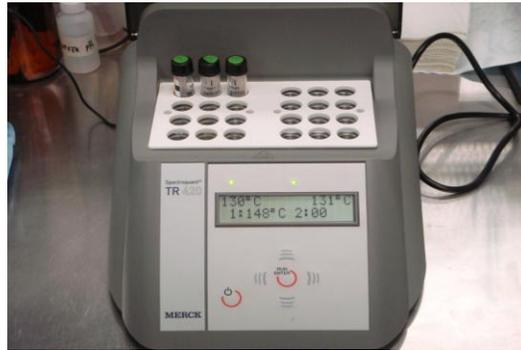
Fig. 2.4 fotografía del termoreactor utilizado para hacer la digestión.
