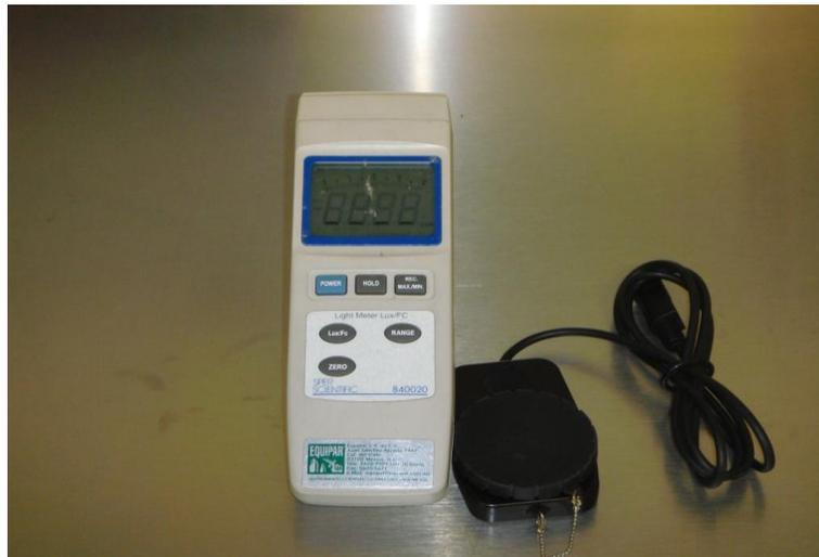
Fig. 2.8 Equipo para medición de intensidad de luz
