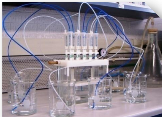
Figura 4.8. Sistema de extracción en fase sólida (SPE).
