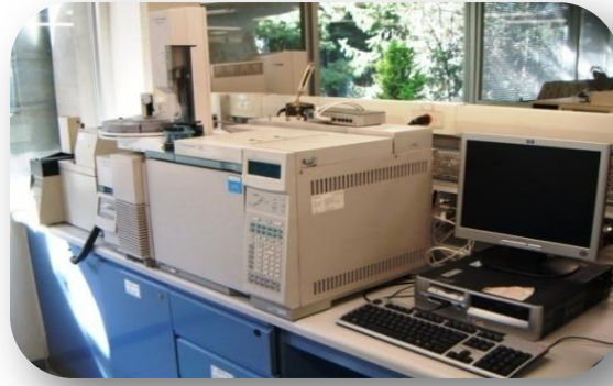
Figura 4.5. Cromatógrafo de Gases HP 6890N, acoplado a un detector selectivo de masas modelo HP 5973N.
