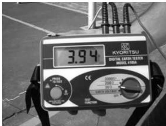
Figura 3.5. Medición de resistividad del terreno por el método del 62%
