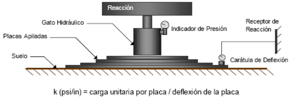
Figura 1.14. Prueba de placa.
