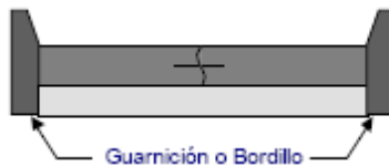
Figura 2.7. Confinamiento con guarnición.
