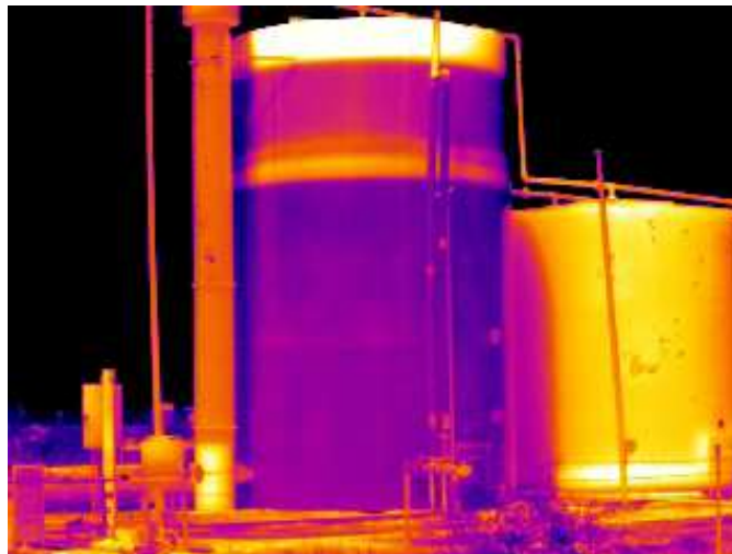
FIGURA 14. TANQUE “GUN BARREL” DE 750 BARRILES DE CAPACIDAD, DESPUÉS DE SER LIMPIADOS
