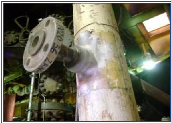
Preparación se superficie y aplicación de líquidos penetrantes
