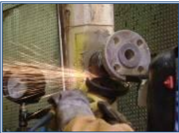
Preparación se superficie y aplicación de líquidos penetrantes
