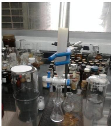
**FIGURA 22.** Columna de cromatografía utilizada en la separación de la formulación
