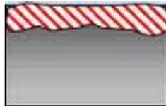
FIGURA 1. Ejemplo de corrosión uniforme
