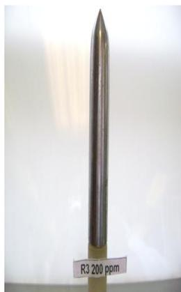
**FIGURA 19.** *Imágenes de cupones utilizados en la prueba de herrumbre “Método estándar de prueba para la determinación de las propiedades corrosivas de corrientes transportadas en tuberías de productos del petróleo NACE TM0172-2001”*
