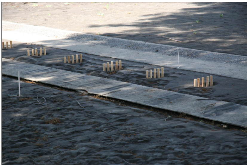
Fig. 6.2.7 Socavación de los tapetes de concreto aguas abajo de la presa tipo indio modificada
