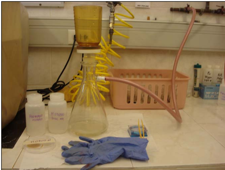
Fig. 4.6 Sistema de filtración magnético Gelman de 47 mm.
