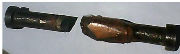
Fig. 5.39. Probeta unida con cobre y después recubierta por encima otra vez con cobre después de hacer el ensayo de tracción o adhesión.
