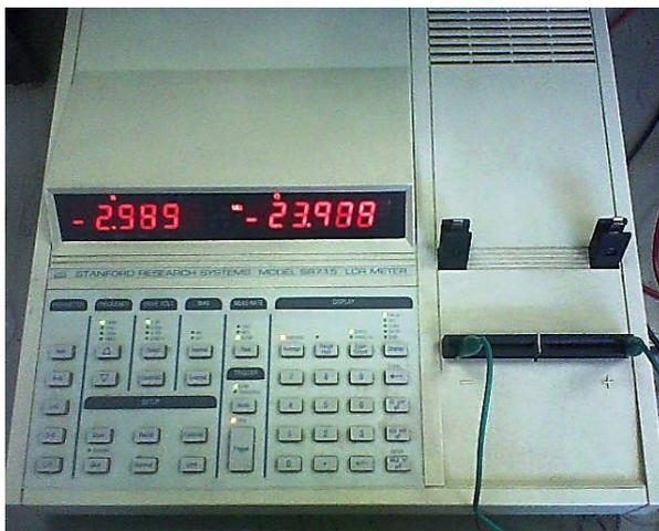
Fig. 5.42. Equipo de puente digital SRS modelo SR715 LCR Meter
