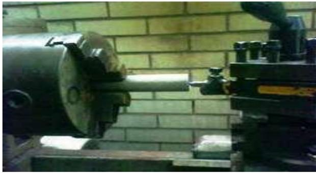
*Fig.5.46. Muestra el maquinado en un torno paralelo antes de proyectarla para que sus dimensiones sean exactas*
