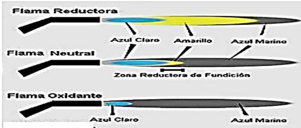
Fig. 3.6. Esquemas de la regularización de la flama.
