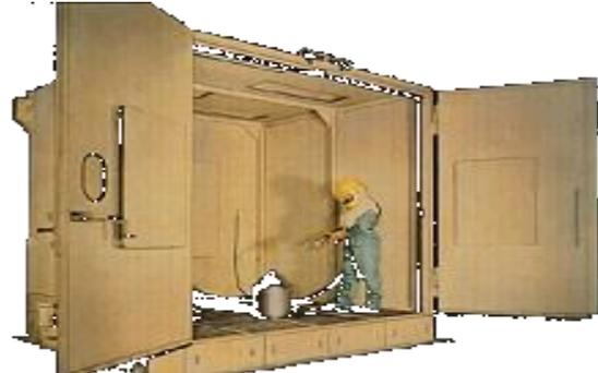
Fig. 1.5 Granallador tipo cuarto.
