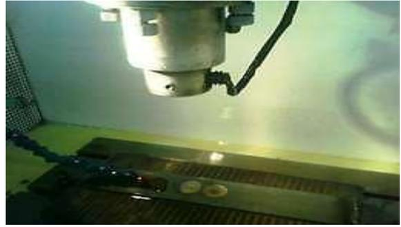
Fig. 5.54. Electroerosionadora de penetración modelo EDM440nc serie L
