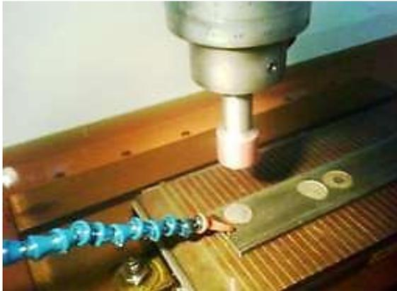
Fig. 5.55. Porta electrodo y electrodo
