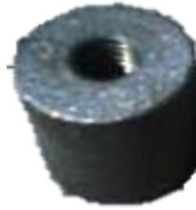
Fig. 4.3. Electrodo granallado y limpio
