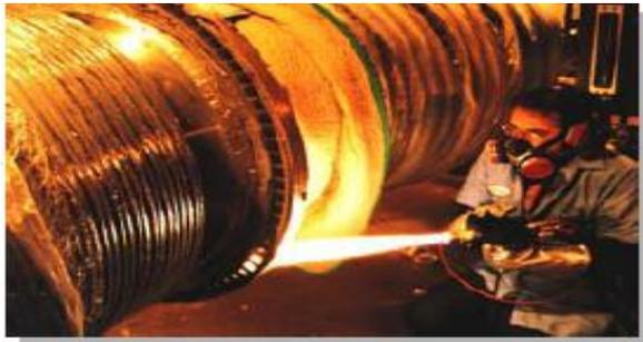
fig.2.14. Proyección en el interior de una turbina
