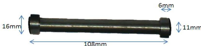
*Fig.5.32. De dimensiones de las probetas utilizadas*
