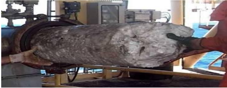
Figura 3.14 Bloqueo por hidratos, (Transferencia tecnológica proyecto D.00378).
