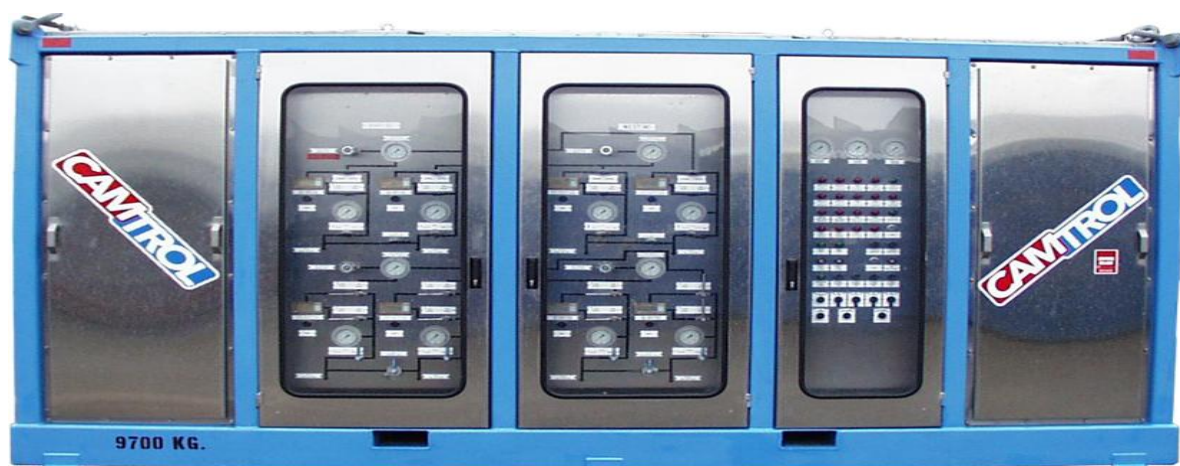
Figura 2.14 HPU, (Cameron, Glosario de sistemas submarinos).
