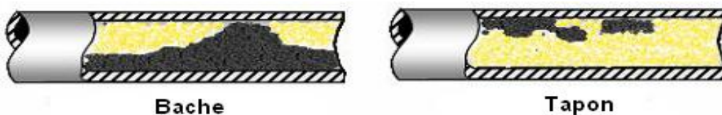
Figura 1.5 Patrones de flujo intermitente, (Beggs y Brill, ESP OIL INTERNATIONAL).
