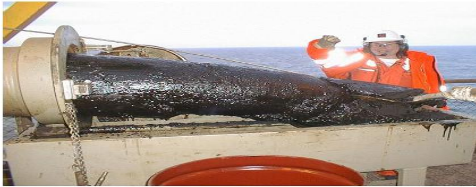
Figura 3.16 Bloqueo por deposición de parafinas y asfáltenos, (Transferencia tecnológica proyecto D.00378).
