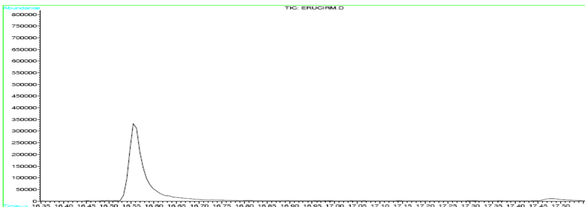
Figura 3.12 Cromatograma del ácido erúxico purificado.
