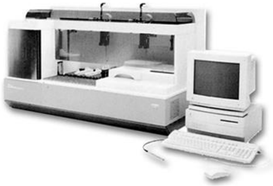
Figura. 2. Esquema de nefelómetro BN II. Behring. Equipo para la determinación de inmunoglobulinas.
