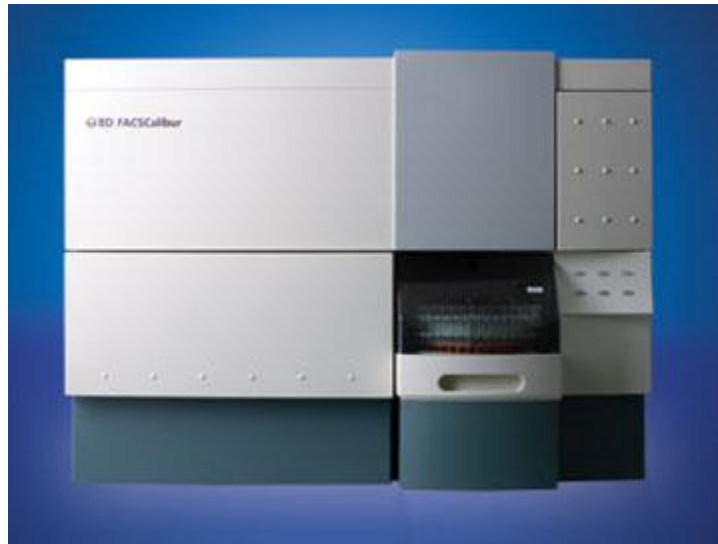
Figura 3. Representación del citómetro de flujo FACSCalibur BD.
