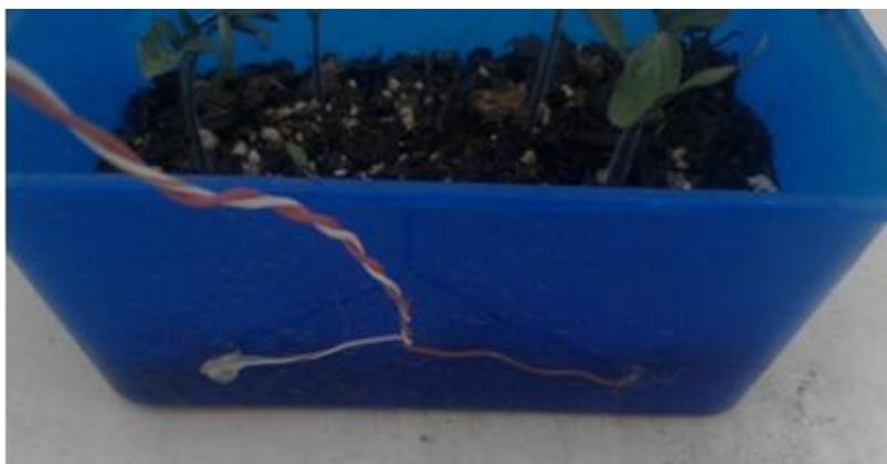
Fig.59.- Sensor que utiliza la conductividad de la muestra.
