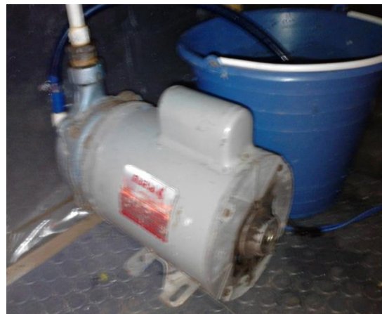
Fig.77.-Bomba de agua de 1/2 Hp.
