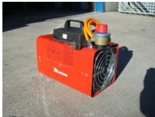
Fig.32.- Generador de aire caliente.
