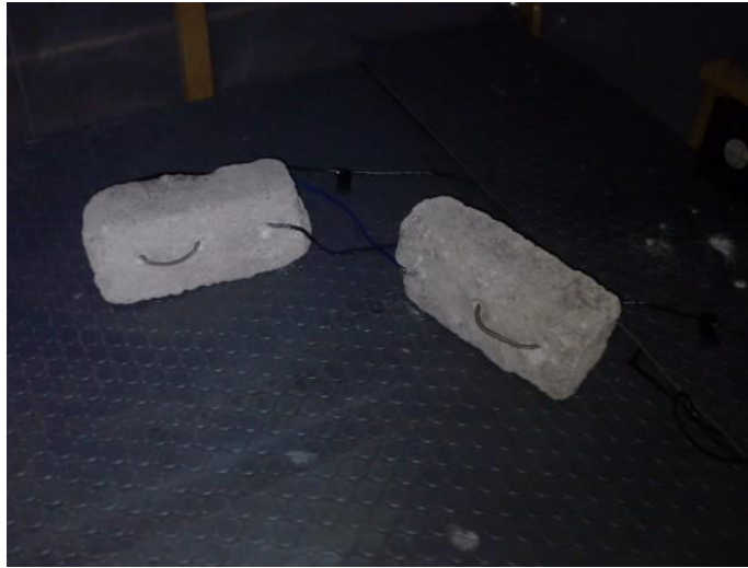
Fig.79.-Calefaccion mediante resistencias eléctricas.
