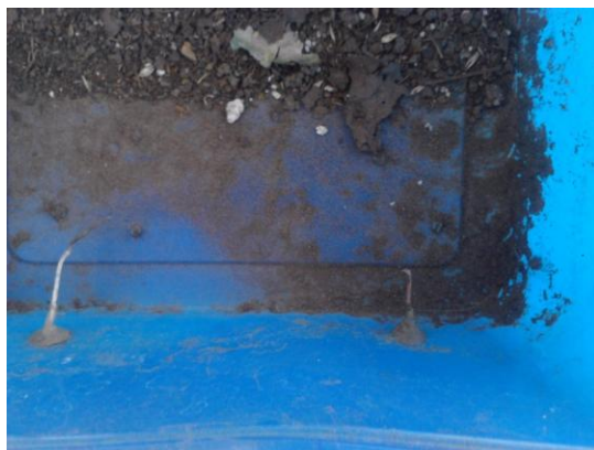
Fig.71.-Sensor de humedad puesta a tierra.
