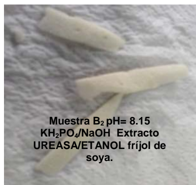
Figura 58. MUESTRA “B 2 y C 6 ” después de la degradación a pH: 8.15
