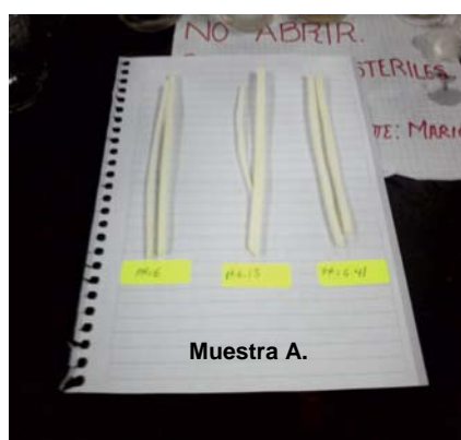
Figura 34. Muestra “A 6.15”, después de la degradación a pH=6.15 Buffer Na 2 HPO 4 /KH 2 PO 4 .
