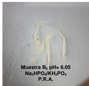
Figura 49. MUESTRA “A 1 y B 2 .” después de la degradación a pH: 6.75, 6.05.
