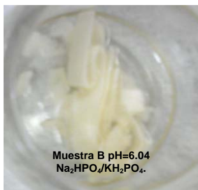
Figura 39. Muestra “B”, afectada por la degradación enzimática a pH=6.04.
