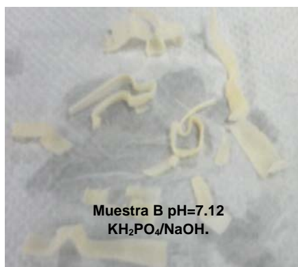
Figura 41. Muestra “B”, después de la degradación a pH=7.12, 7.0 con enzima Papaína.
