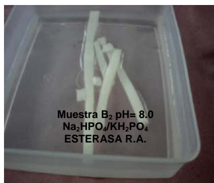
Figura 73. MUESTRAS “A 3 , B 1 , B 2 y C 3 ” después de la degradación a pH= 8.0
