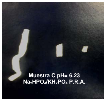
Figura 45. MUESTRA “A y C” después de la degradación a pH: 6.11, 6.23.
