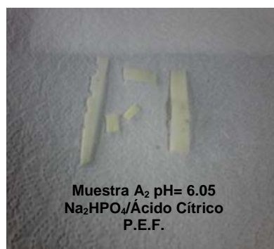
Figura 49. MUESTRA “A 1 y B 2 .” después de la degradación a pH: 6.75, 6.05.
