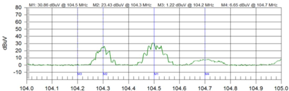
Figura 6.7. Espectro de la señal híbrida transmitida con interferencia (señal de FM y de DRM+).
