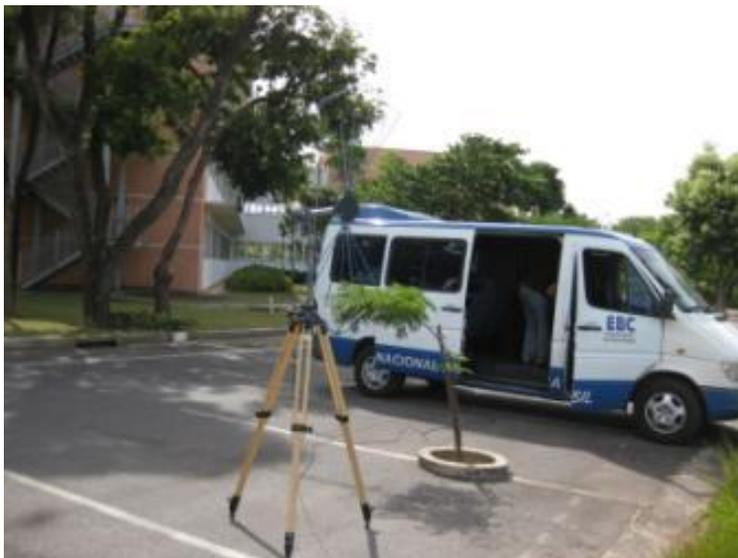
Figura 6.2. Vehículo utilizado para realizar las pruebas fijas y de movimiento con la antena bicónica utilizada en UFMG.
