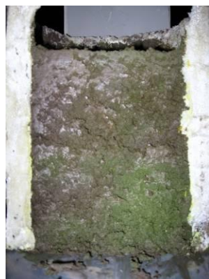
Figura VII.43. Secuencia de imágenes que muestran el procedimiento de corte de las columnas una vez aplicada la lámina de riego con el colorante fluorescein.
