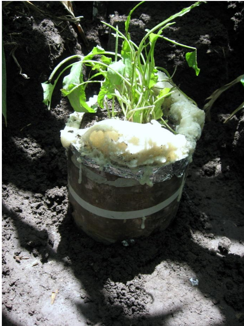
Figura VII.40. Columna de suelo (monolito) con molde de acero y espuma.
