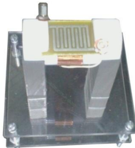
Figura IV.5. Estructura mecánica que mantiene al sensor fijo.
