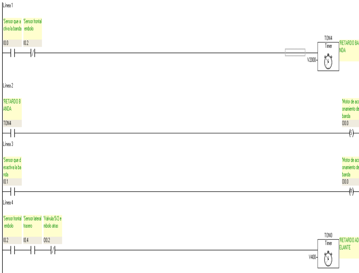
Figura 3.5: Programa en lenguaje de escalera para la estación (Parte1)
