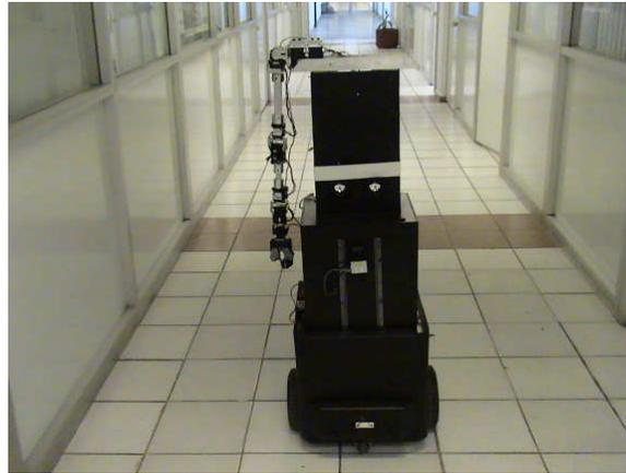
Figura 5.3. Robot Pac-Ito del Laboratorio de Biorrobótica de la UNAM. El robot utiliza un sensor láser de proximidad para percibir información de su ambiente.
